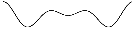
図 14: USB から得られる音声波形. 混信の影響を受けている側である.
